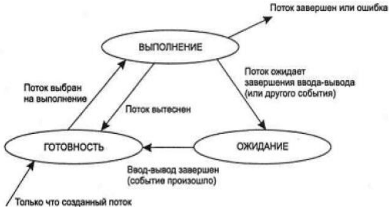
Рисунок 3.1 – Граф состояний потока в многозадачной среде
